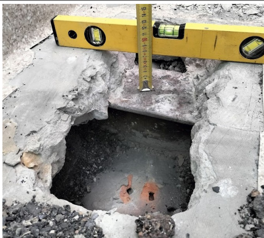
Fot. 1 - Odkrywka stropu nad I piętrem. Pomiar grubości jastrychu.
